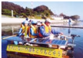
ペットボトルや間伐材を再利用したユニークな手づくりソーラーボート（佐鳴湖）
